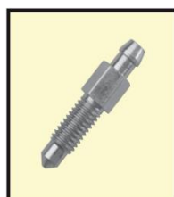
Ref: 889 600 16 Tornillo Purgador/ freno CAJA 10/Un M 8 x 1,25 SW 9 x 41,5
