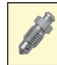
Ref: 889 616 16 Tornillo Purgador/ freno CAJA 10/Un M 8 x 1,25 SW 8 x 24,5
